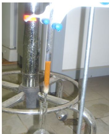
تصویر ۱: الف - نمای کلی پایلوت ب - ستون حاوی رزین
