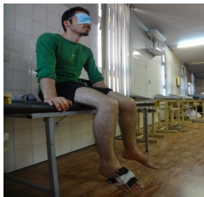
تصویر ۱: نحوه ی قرار گیری و اندازه گیری خطای بازسازی زاویه بوسیله ژيروسکوپ
