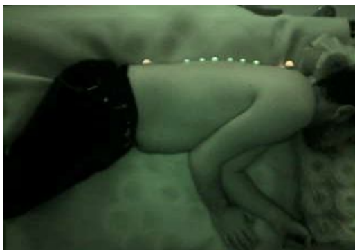
شکل ۵: تصویر اخذ شده توسط دوربین بالا بر روی سطح چیدمان سفارشی به منظور تنظیم راستای قرارگیری، دو نشانگر راهنمای ناحیه‌شانه‌ای بر روی هم و دو نشانگر ناحیه لگنی بر روی هم قرار دارند
