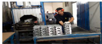
تصویر ۱. عملیات فرزنی در زیروظیفه پلیسه‌گیری
