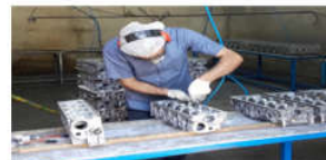
تصویر ۲. تخلیه بعد از شستشو در زیروظیفه شستشو
