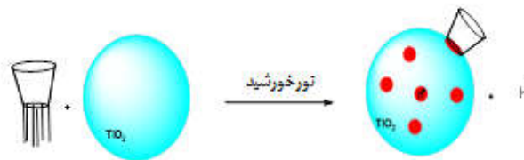
شکل ۳. اندازه گیری تغییرات اسیدیته محیط شامل تیتانیا و سیکلودکستین تحت تابش LED در نتیجه پروتون زدایی از گروه های هیدروکسیل سیکلودکستین روی سطح \text{TiO}_2 .
