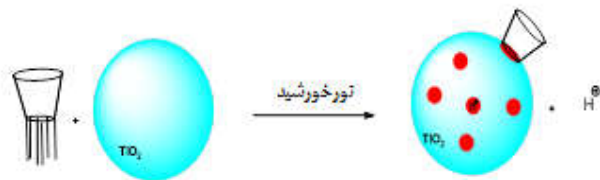
شکل ۳. اندازه گیری تغییرات اسیدیته محیط شامل تیتانیا و سیکلودکسترین تحت تابش LED در نتیجه پروتون زدایی از گروه های هیدروکسیل سیکلودکسترین روی سطح TiO_2 .
