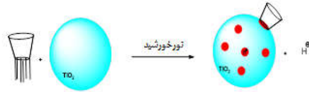
شکل ۳. اندازه گیری تغییرات اسیدیته محیط شامل تیتانیا و سیکلودکستین تحت تابش LED در نتیجه پروتون زدایی از گروه های هیدروکسیل سیکلودکستین روی سطح TiO_2 .
