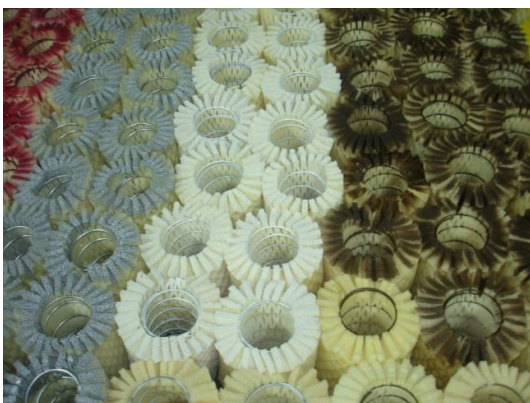
شکل ۳: المان‌های فوم- فتر چیده‌مان شده در قاب، رنگهای مختلف نشان دهنده سفتی‌های متفاوت در این تشک می‌باشد.
