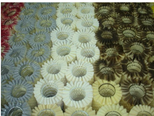
شکل ۳: المان‌های فوم- فتر چیده‌مان شده در قاب، رنگهای مختلف نشان دهنده سفتی‌های متفاوت در این تشک می‌باشد.
