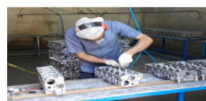
تصویر ۱. عملیات فرزنی در زیروظیفه پلیسه‌گیری
