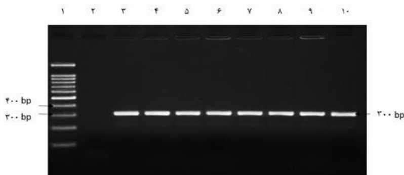
شکل ۲: نتیجه الکتروفورز محصول کلنی PCR بر روی ژل آگارز ۲ درصد ردیف ۱: نشانگر DNA 100 bp (Fermentas) ردیف ۲: کنترل منفی ردیف ۳ تا ۱۰: محصولات کلنی PCR به ترتیب برای کلنی‌های شماره ۱، ۲، ۳، ۴، ۵، ۶، ۷، ۸ در ردیف‌های ۳ تا ۱۰ قطعات تکثیر شده بخشی از ژن NP را نشان می‌دهند
