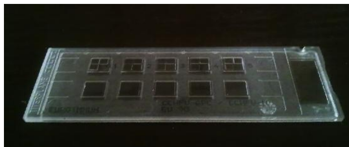
تصویر ۱: لام ایمنوفلورسنت با Biochip پوشیده با سلول های حاوی ویروس CCHF
